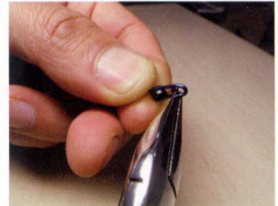
テンプレのU字部にヒンジパーツを取り付ける。U字部をヤットコで広げてヒンジパーツをバチンと差し込む。
