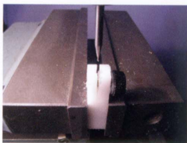
ヒンジパーツに縦の溝を入れる作業。ヒンジパーツも外注されるが、二次加工は工房で行われる。
