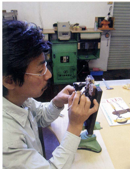
「コンセプトY」を量産するためのロウ付けの治具も兵井伊佐男自身が開発したものである。写真は、ロウ付け作業(ガストーチによる)の兵井伊佐男と「コンセプトY」をつくるための専用の工具。(左)
