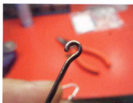
レンズリムは自動機で製作し、ワンオフ工房に納品されるが、フック部の形状は、手作りの専用パンチを使って整形する。
