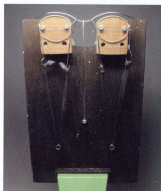
兵井自身が開発製作した口ウ付け作業のための治具。
