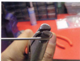
テンプルの形状は単純なので、線材を一定の長さで切断し、専用のヤットコで一本一本U字部を成形する。
