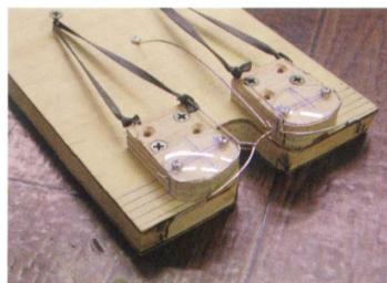
コンセプト「Y」を組み立てるための手製の治具
